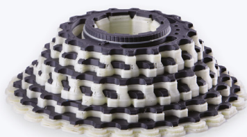
Prototyp wielotrybu kasetowego przed rozpuszczeniem podpór
